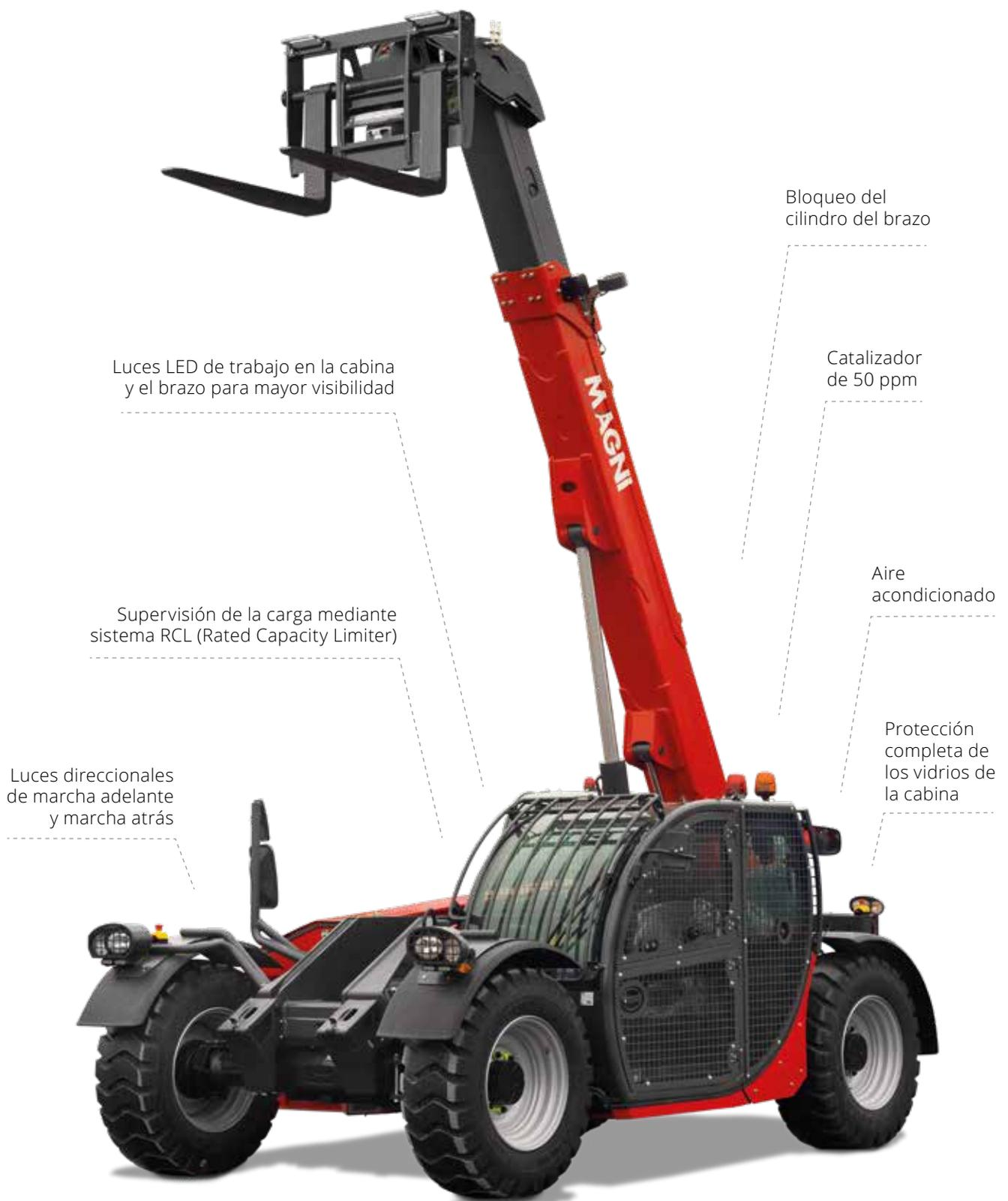
El modelo THU 5.8 presenta un perfil bajo y una altura máxima del vehículo de 2 metros, por lo que es idóneo para entrar en los espacios angostos típicos de las galerías y otros lugares de extracción mineral. Gracias a su diseño compacto, esta máquina de dimensiones reducidas ofrece una maniobrabilidad excelente. Sin embargo, la transmisión hidrostática y las cuatro
